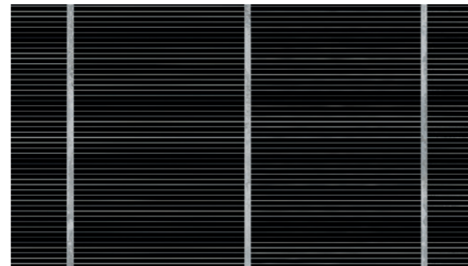
Zelle eines monokristallinen PV-Moduls mit sichtbaren Leiterbahnen
